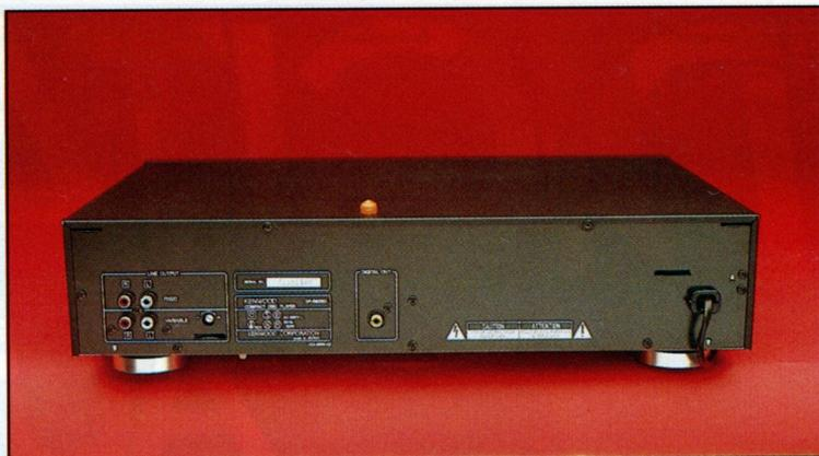
Oltre alle uscite analogiche (fissa e variabile), il DP-880SG mette a disposizione anche una presa digitale elettrica.
