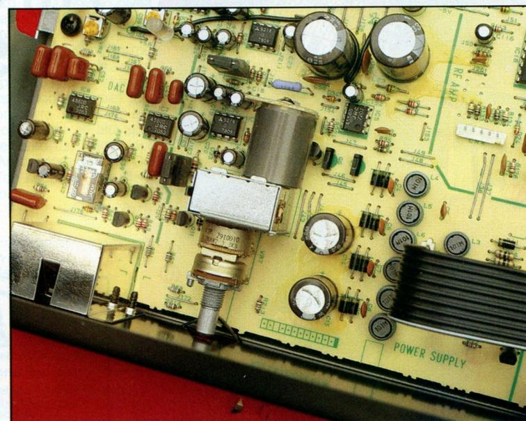
Il doppio potenziometro con motore elettrico che permette di regolare il livello di uscita anche dal telecomando.
